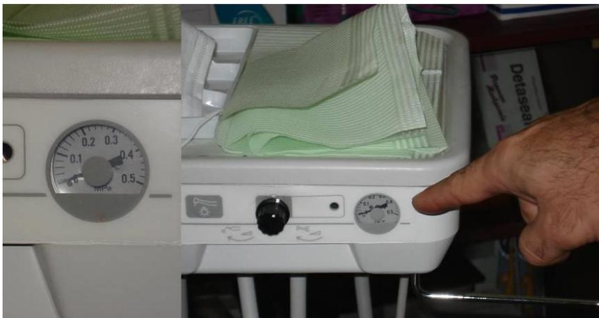
治療台的壓力表因管線壓降的因素，需高於手機進氣壓力
